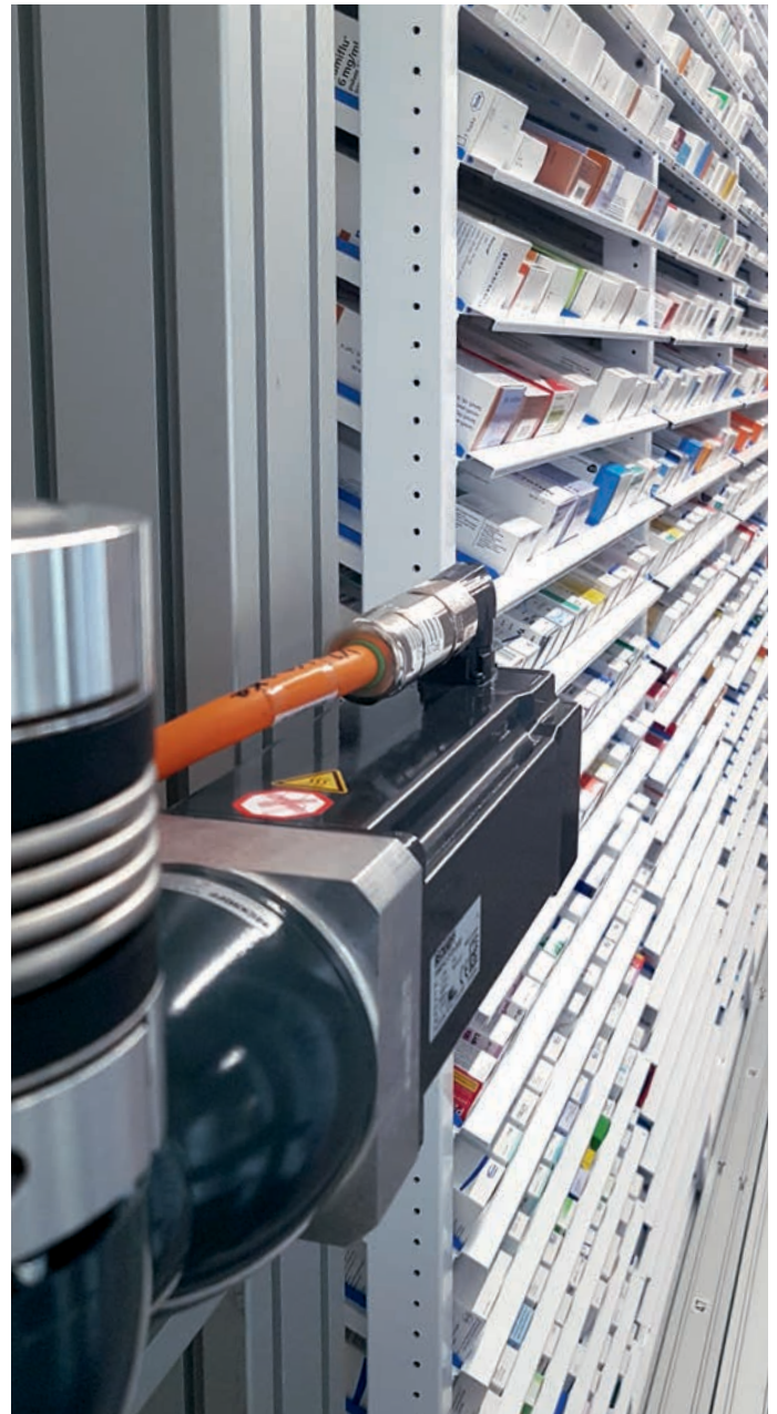
Die Servomotoren der Serie AM8000 mit One Cable Technology sorgen für die korrekte Positionierung des Roboters beim Handling der Arzneimittelpackungen.
